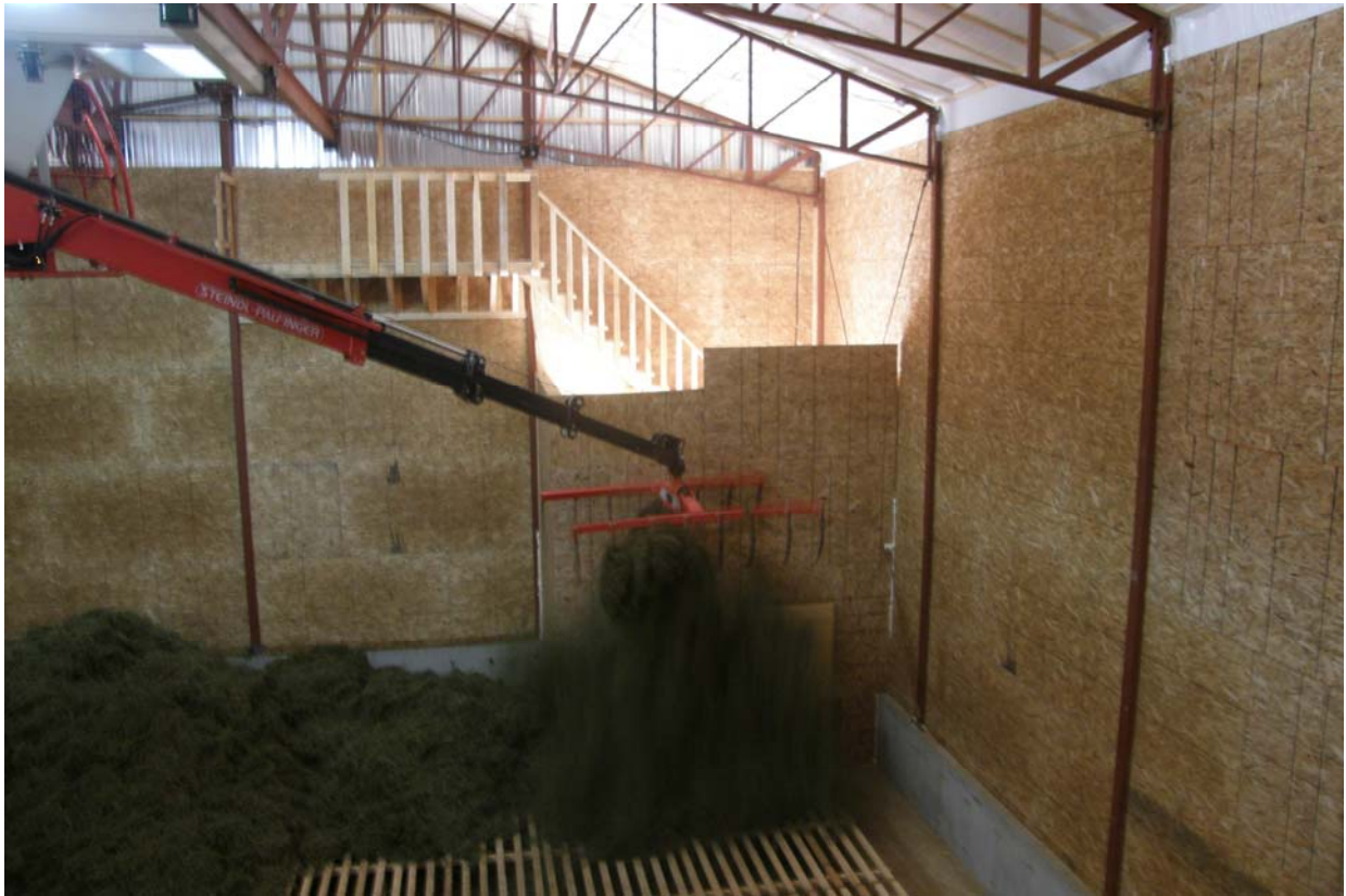
Figure 5 : Manutention avec la griffe à foin. Noter l'espace libre entre le caillebotis et le mur qu'il faut placer en premier https://www.youtube.com/watch?v=Svsts39Xdrw
