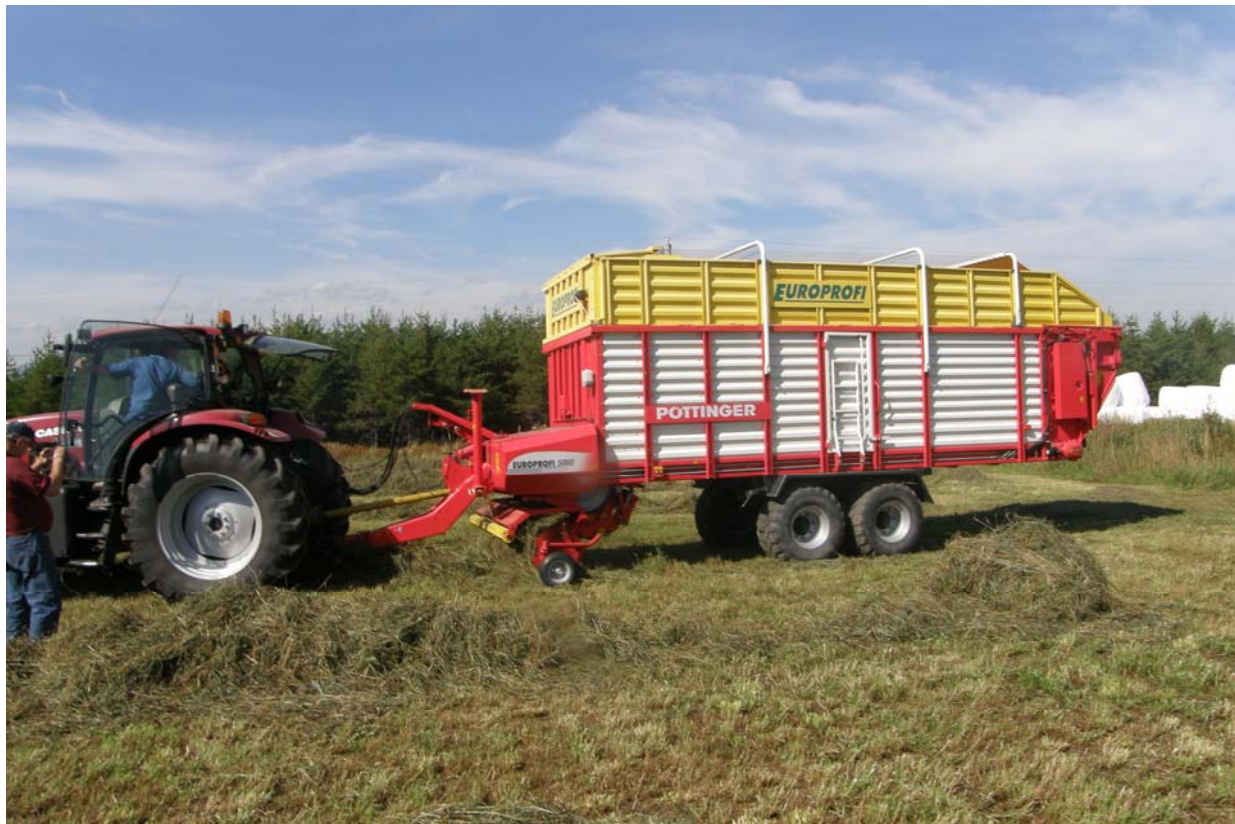
Figure 2 : Autochargeuse Pottinger 50 m 3 utilisée à la ferme Hengil http://www.youtube.com/watch?v=3AW9CQ31SXc&feature=youtu.be
